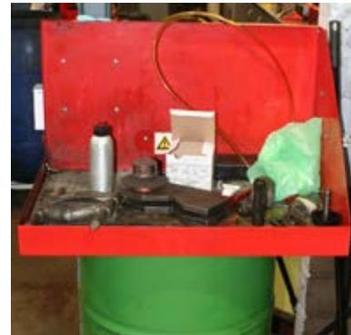
Kleinteilereiniger: Klappdeckel, die bei Nichtbetrieb geschlossen werden.
