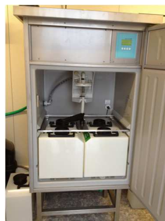
24h- Probenehmer Probenahmegerät mit 4 Sammelbehälter 20l für Laboranalysen und Rückstellproben. Steuerung zulaufproportional, umstellbar auf zeitproportional.
