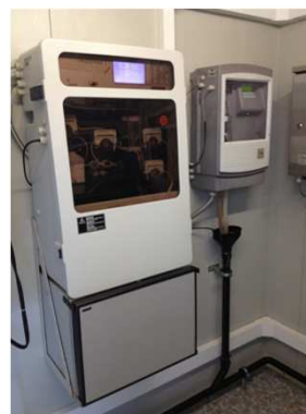
Plot und PO4-P Analyse Vollautomatisches Online Analysegerät zur Messung von P-gesamt und Ortho-Phosphat. Messintervall 10 Minuten Gerät rechts: Probenvorbereitung.
