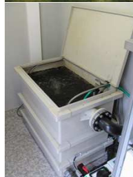
Probebecken mit Entnahmesonden und eingesetzten Messgeräten
